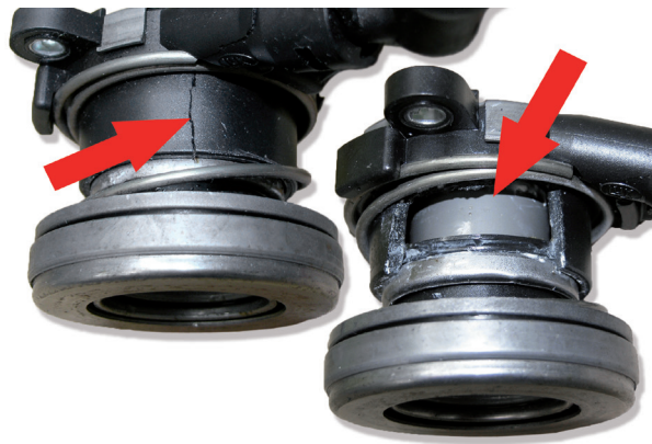
Bild 5: Durch Falscheinbau zerstörte Zentralausrücker
