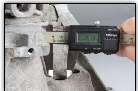
Bild 2: Ist der Durchmesser kleiner als 21 mm, muss auf mind. 21 mm, max. 24 mm aufgebohrt werden
