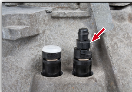
Bild 8: Der Entlüfternippel kann mit der Hand oder mit einem Maulschlüssel (SW 13) betätigt werden
