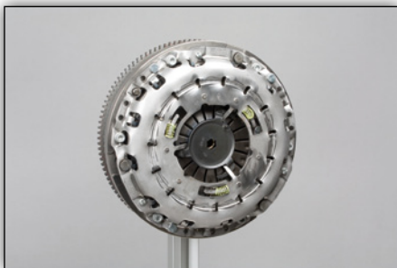
Bild 7: Kupplungsdruckplatte anbringen und Schrauben mit dem vom Fahrzeughersteller angegebenen Anzugsdrehmoment festziehen
