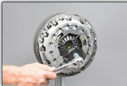
Bild 8: Verriegelungsstück mit geeignetem Werkzeug herausdrehen und entfernen. Es wird nicht weiter benötigt
